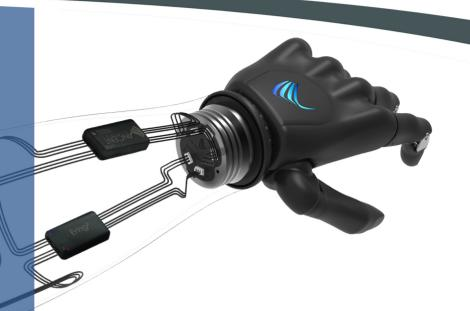
Die VINCENTemg2 ist die derzeit kleinste digitale Oberflächenelektrode zur Messung von Muskelaktionspotentialen für die Steuerung von myoelektrischen Prothesen, mit zwei Kanälen.
